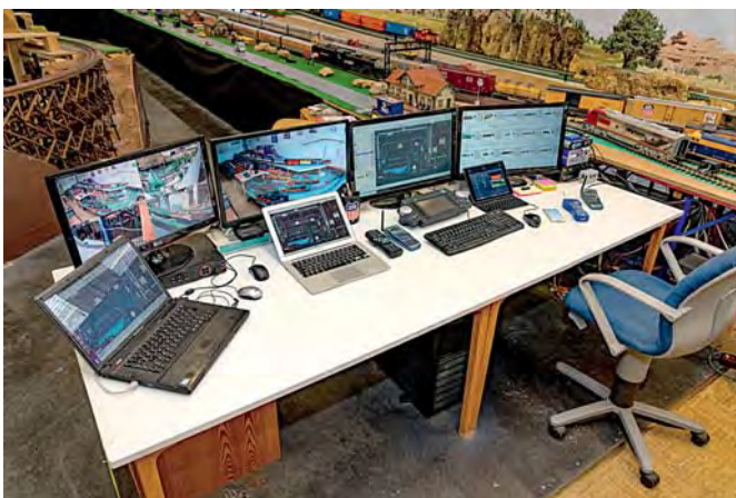
Vier große 27"-Monitore dominieren den Leitstand der Anlage. Hier werden alle wichtigen Streckenabschnitte und der große Schattenbahnhof mittels Kameras beobachtet. Für die Steuerung ist iTrain zuständig. Die Anlage kann mit den Laptops, Tablets und Smartphones via WALN auch vor Ort an jedem Punkt bedient werden.
