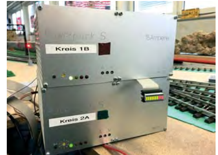
Der Strombedarf der Anlage ist gewaltig. Die Heller-DCC-Booster liefern jeweils bis zu 15 A pro Gleisabschnitt.
