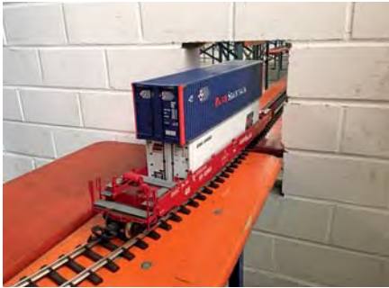
Höhentest mit einem Doppelstock-Containerwagen beim Mauerdurchbruch für die Zufahrt zum Schattenbahnhof im Nachbarraum.
