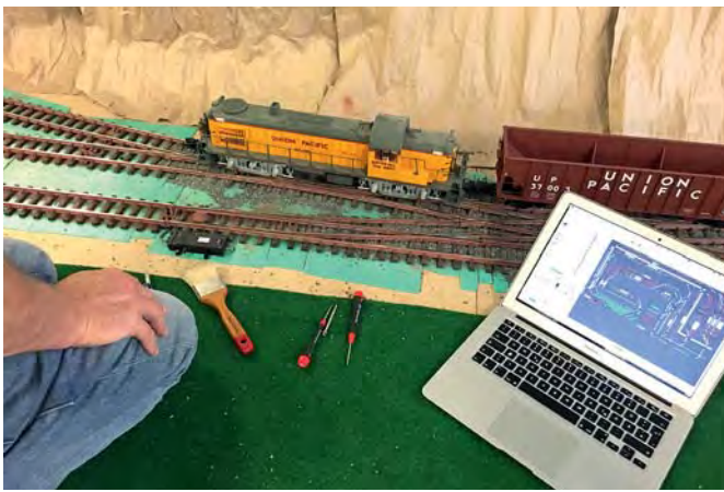
Direkt an der Anlage werden die Weichenantriebe per iTrain auf dem Laptop eingestellt, ihre exakte Lage justiert und die Funktion getestet.
