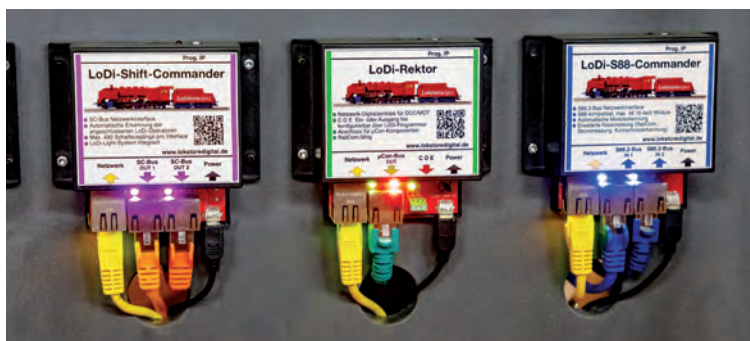
Der Hersteller empfiehlt, für die verschiedenen Aufgabenbereiche der Anlagenverkabelung unterschiedliche Kabelfarben einzusetzen.
