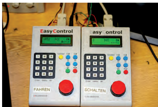
Die eine zum Fahren, die andere zum Schalten von Weichen und Signalen: Die zwei EasyControl von Tams erzeugen alle nötigen DCC-Signale.
