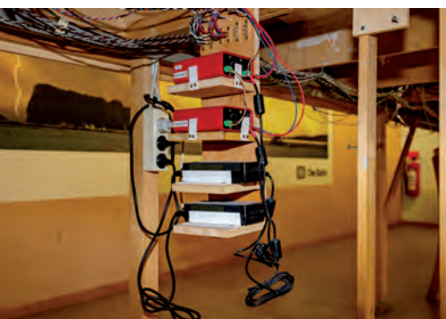
Mehrere DCC-Booster von Tams sorgen für die erforderliche Power auf den Strecken.
