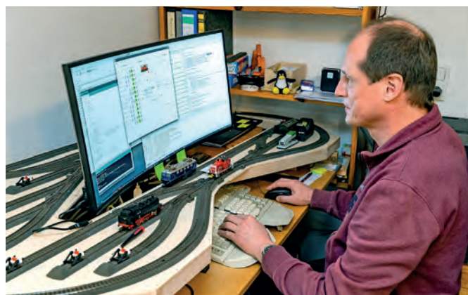
Peter Rudolph an seinem Entwickler-Arbeitsplatz. Die Teststrecke ist schief liegend aufgebaut um die Lastregelung der Motoren besser einstellen zu können.
