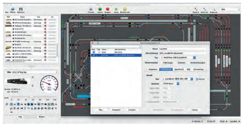
Eine der unterschiedlichen Darstellungsmöglichkeiten von iTrain: Links die Übersicht der Lokomotiven, darunter ein „Fahrpult“ zum Fahren und Steuern aller Funktionen der dort ausgewählten Lok, rechts das Gleisbild, hier gerade überlagert von einem Einstellungsdialog zur Definition der verwendeten Zentralen.
