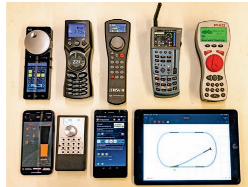
Welchen Funk-Handregler hätten's denn gerne? Immer mehr Zentralen erlauben den Einsatz auch markenfremder Bediengeräte, außerdem lassen sich Smartphones und Tablets nutzen: ESU Mobile Control, Roco WLAN Maus, Uhlenbrock Daisy II, Zimo MX32, Piko Navigator (Massoth), Smartphone mit App Roco Z21, Funky II und Software auf Smartphone und Tablet (von oben links nach rechts).
